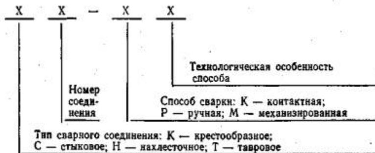
Пример условного обозначения стыкового соединения, выполненного ванной механизированной сваркой под флюсом в инвентарной форме, положение стержней вертикальное:
