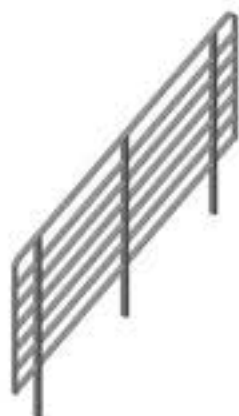
ОГРАЖДЕНИЯ ЛЕСТНИЧНЫХ МАРШЕЙ
